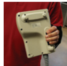
Schalttafeleinbau eines JSHD4H2-Schalters an einem Programmiergerät für Roboter.
