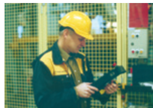
Zustimmungsschalter, angeschlossen an eine Maschinensteuerung.
