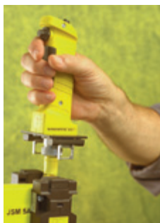
Zustimmungsschalter, angeschlossen an eine Maschinensteuerung.
