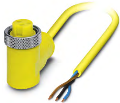
Sensor-/Aktor-Kabel, 3-polig, PVC, gelb RAL 1021, freies Leitungsende, auf Buchse gewinkelt 7/8"-16UNF, A-kodiert, Kabellängen: 2m / 4m / 6m
