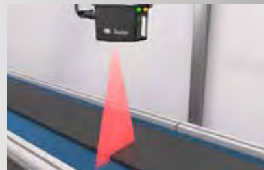
Höhenmessung von Gummibändern
