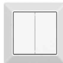
Mit den Produkten aus der AIMOTION Switch 55 Serie können einzelne Leuchten, Leuchtengruppen, alle Leuchten eines Netzwerks, Elemente, Szenen, Animationen und Farbtemperatur gesteuert werden. Der Wandschalter Switch 55 ist frei platzierbar und basiert auf dem wartungsfreien Bluetooth Low Energy Sendermodul PTM 215B von EnOcean, welches durch Tastendruck Energie erzeugt. Die Tasten können individuell belegt werden. Die Einstellung erfolgt über die Casambi App.
