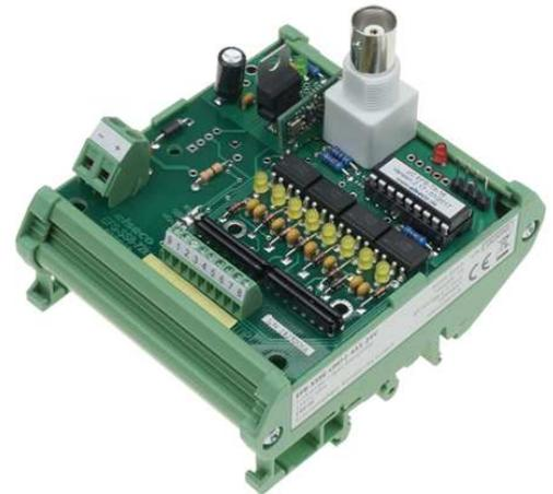
stationärer Funksender EFS-SSxE-UM72
