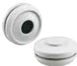
Doppelmembranstutzen, IP66, mit zwei Dichtungsmembranen, geschlossen, thermoplastisches Elastomer (TPE), für Wandstärken 1,5 - 4,5 mm, grau
