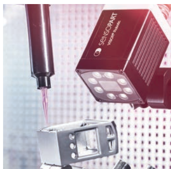
Der VISOR® Robotic ermittelt präzise die Lage des Sensorgehäuses. Die Offsetdaten werden dazu verwendet, um die Roboterbahn zu korrigieren.
