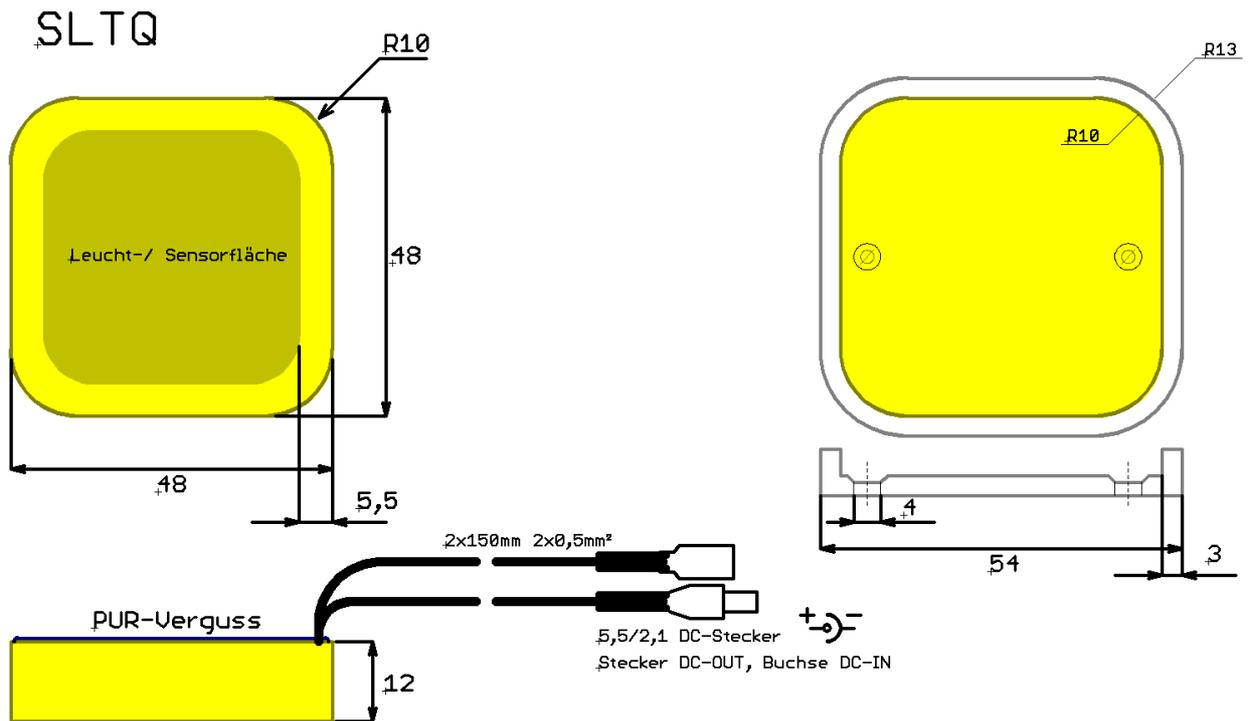
Bild 2: Abmessungen (Angaben in mm) Sensor mit DC-Kabeln und Montagesockel
