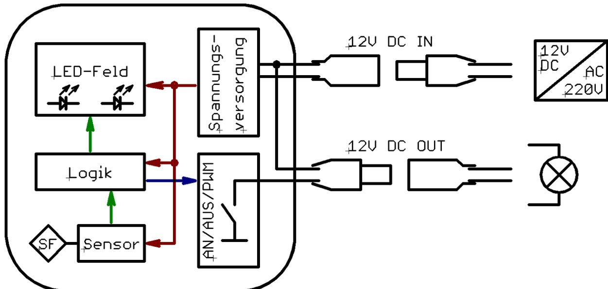
Bild 1: Schaltschema (DC-Anschlüsse mit Verbraucher und Netzteil)
