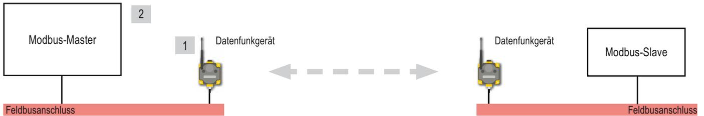
In diesem Beispiel-Netzwerk sind die erweiterten externen DX85-Ein-/Ausgangsgeräte an den Datenfunkgeräten angeschlossen und fungieren als Modbus-Master oder -Slaves. Die Datenfunkgeräte vergrößern weiterhin die Reichweite des Modbus-Netzwerks.
