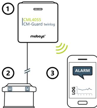
Der Mobeye CML4055 überwacht den Spannungswert einer angeschlossenen Batterie oder eines analogen Sensors. Es misst die Werte kontinuierlich, um bei Abweichungen sofort zu alarmieren, und protokolliert diese periodisch.
