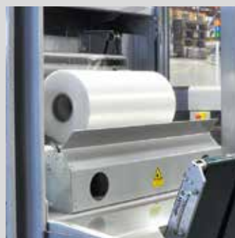
Laufende Überwachung des Durchmessers eines Coils, z.B. bei Verpackungsmaschinen
