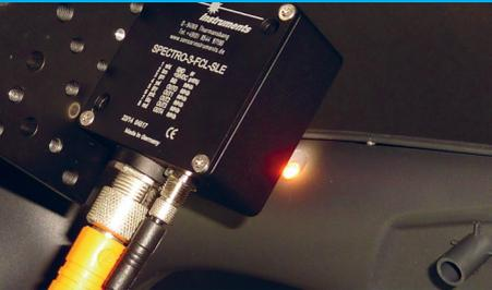
Die Farbe sowie die Intensität von LEDs, integriert in Kunststoffkomponenten für den Interieurbereich, soll überwacht werden. Hier kommt ein Farbsensor vom Typ SPECTRO-3-FCL-SLE zum Einsatz. Der Sensorabstand zur LED beträgt dabei ca. 25 mm.
