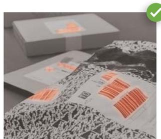
Dank dem speziell entwickelten Algorithmus für die „Key Region Detection“-Funktion konzentrieren sich die kamera-basierten Codeleser ausschließlich auf die Decodierung der relevanten Bildbereiche (in Echtzeit). Das ermöglicht eine besonders schnelle interne Datenverarbeitung und höhere Durchsatzraten für logistische Anwendungen.
