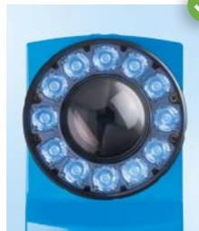
Die Beleuchtung von Codelesern darf Arbeitskräfte nicht stören oder blenden. Daher bietet die Lector®-Serie eine Variante mit Infrarotlicht. Die Wellenlänge der LEDs ist im nicht sichtbaren Spektrum und stellt weiterhin eine verlässliche Erkennung sicher. Umliegende Arbeitsplätze werden durch die Codeerfassung nicht beeinträchtigt. Das ermöglicht ungestörtes Arbeiten in direkter Nähe zu kamerabasierten Codelesern.
