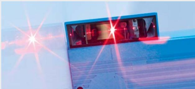
Laserbasierte Barcode-Scanner besitzen eine hervorragende Schärfentiefe und können deshalb Barcodes auf unterschiedlich hohen Objekten ohne Probleme identifizieren. Durch den großen Öffnungswinkel von bis zu 60° lassen sich durch nur ein Gerät die meisten Förderbandbreiten abdecken.
