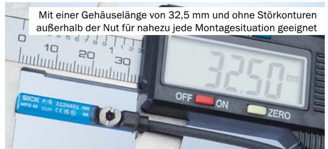
Mit einer Gehäuselänge von 32,5 mm und ohne Störkonturen außerhalb der Nut für nahezu jede Montagesituation geeignet
