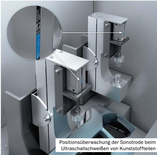
Positionsüberwachung der Sonotrode beim Ultraschallschweißen von Kunststoffteilen
